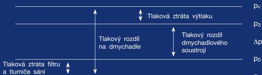
$p_s$  – tlak na sací přírubě dmychadla, je nižší než tlak atmosférický o tlakovou ztrátu na filtrační vložce a v tlumiči sání
