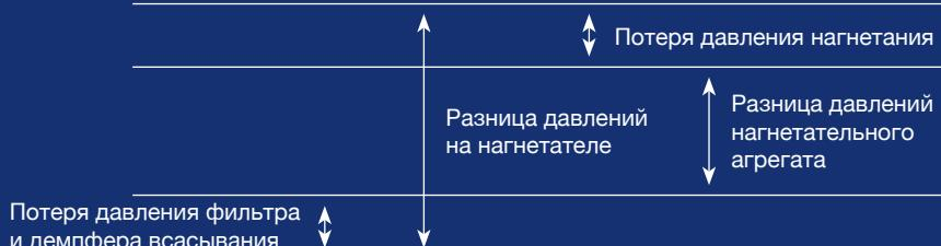
$p_s$  – давление на всасывающем фланце нагнетателя, меньше атмосферного давления на величину потери давления на фильтровальном вкладыше и в демпфере всасывания
